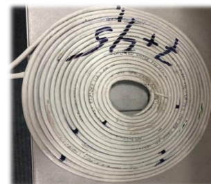
Рисунок 3.11– Образцы кабелей и проводов и их размещение в муфельной печи:
