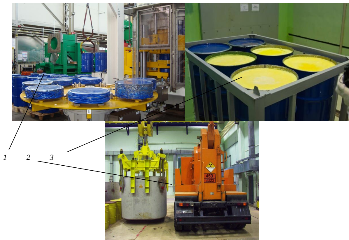
Рисунок 2.27 – Наиболее опасное расположение горючей нагрузки в помещении по обращению с ОНУА: 1 – технологическая линия; 2 – электропогрузчик; 3 – бочки с ОНУА на электропогрузчике (6 штук)
