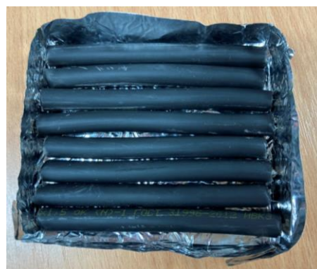
Рисунок 4.8 – Внешний вид силового кабеля, с медной жилой, изоляцией из ПВХ, оболочкой из ПВХ пониженной горючести «ВВГнг (А)-FRLS 2x1,5» (а) и образца для проведения эксперимента (б)
