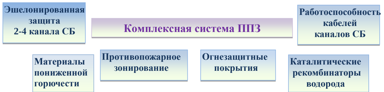
Рисунок 1.4 – Состав комплексной системы ППЗ АЭС с ВВЭР
