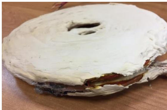
Рисунок 3.16 – Внешний вид образца кабельной линии типа КМВЭВ 1×2×1,5 при воздействии реального температурного режима пожара с огнезащитным покрытием «Огнеза-ВД-К»
