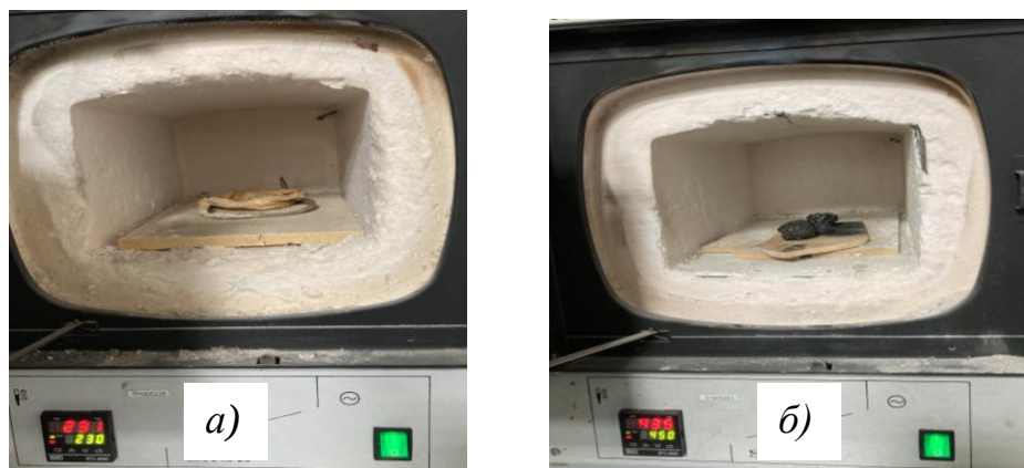
Рисунок 3.14 – Внешний вид образца кабеля с огнезащитным покрытием «Огнеза-ВД-К»: а – до вспучивания (230°С ); б – после вспучивания (450°С )
