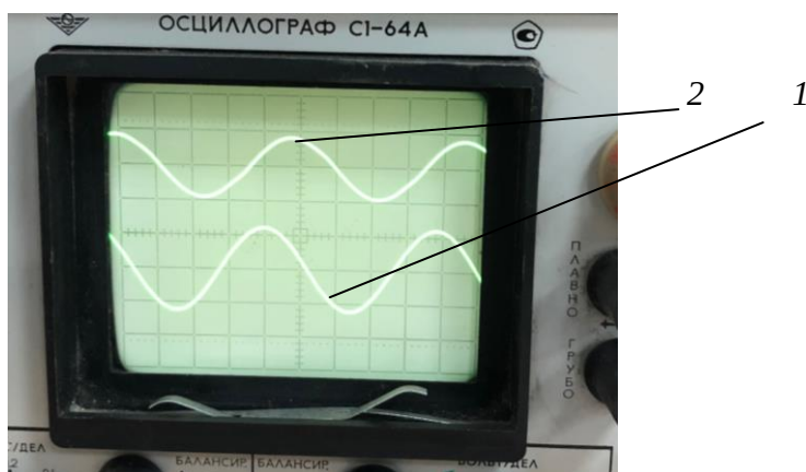
Рисунок 3.12 – Визуальный контроль формы сигнала с двухжильного нагревательного провода типа ПНСВ 1×1,2 на экране осциллографа в момент стабилизации сдвига фазы и изменения амплитуды сигнала на спектрограмме: 1 - образцовый сигнал; 2 - сигнал с выхода испытуемого образца
