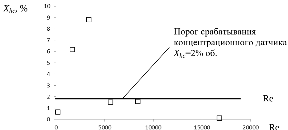
Рисунок 5.20 – Зависимость объемной концентрации водорода в верхней точке купола (место расположения концентрационных датчиков водорода) от числа Рейнольдса при различных диаметрах отверстий истечения водорода ( d = 1 \text{ м}; 0,1; 0,05; 0,03; 0,025; 0,01 \text{ м} )
